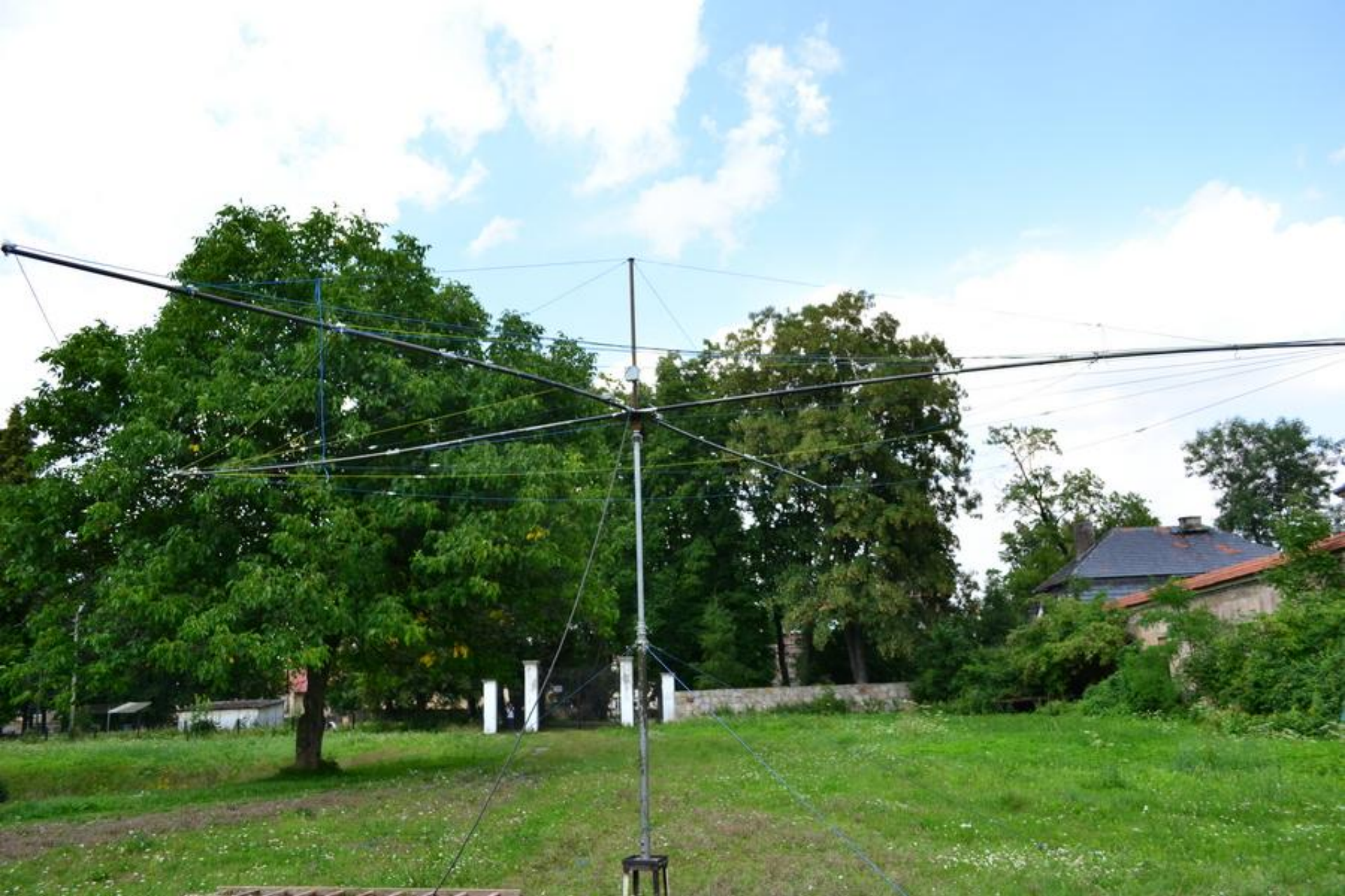
Kompletna antena SPIDERBEAM na maszcie
